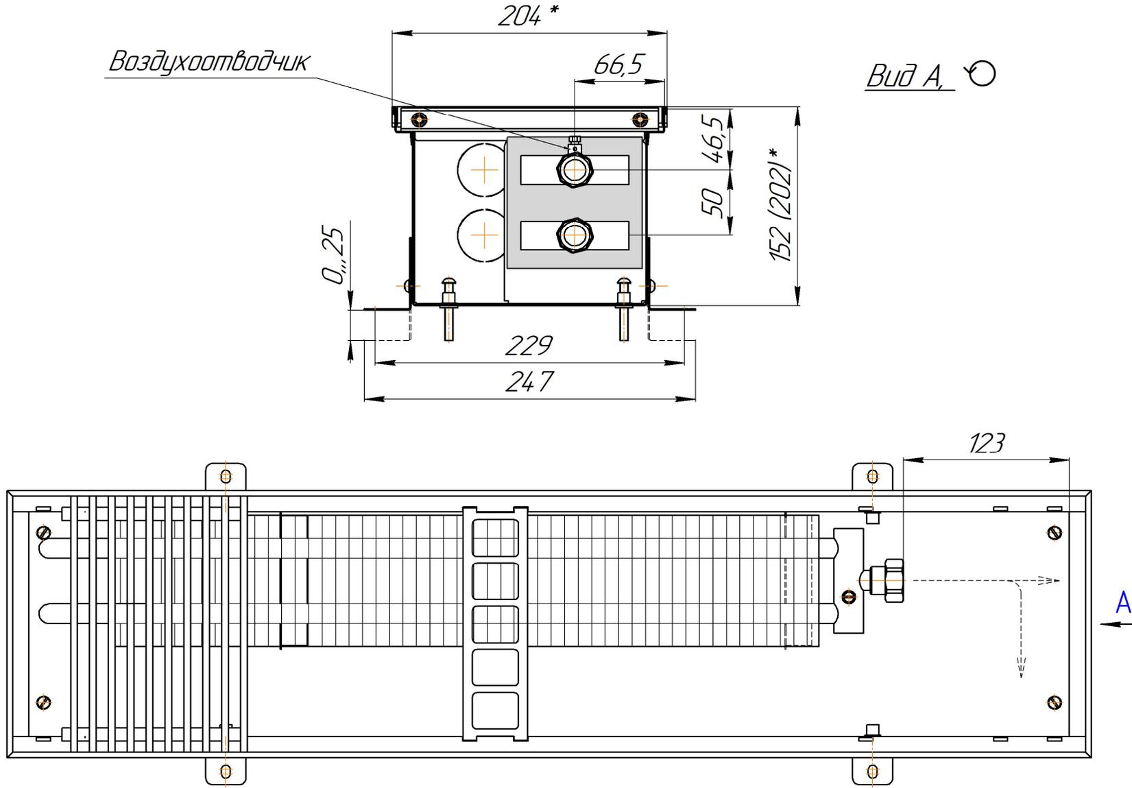
Монтажная схема ZOLTER ZN 200.150 (200) 2,5-5,0м
