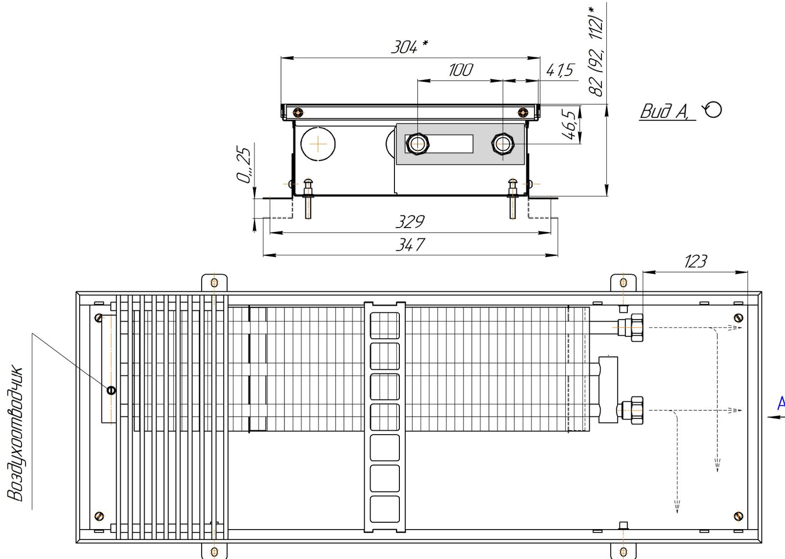
Монтажная схема ZOLTER ZN 300.80 (90, 110) 2,5-5,0м
