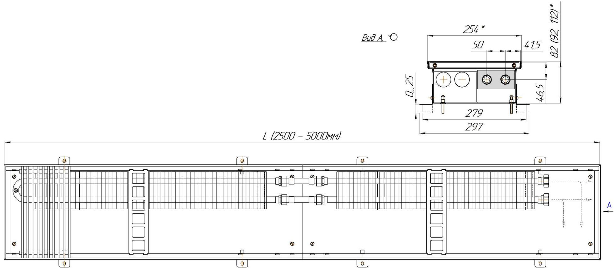
Монтажная схема ZOLTER ZN 300.150 (200) 0,8-2,4м
