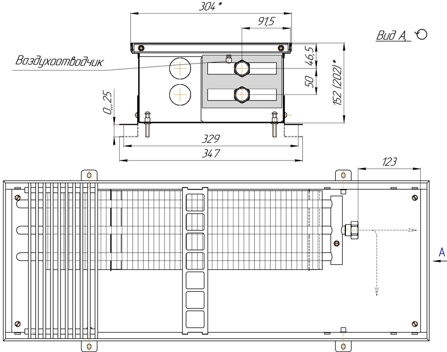
Монтажная схема ZOLTER ZN 300.150 (200) 2,5-5,0м
