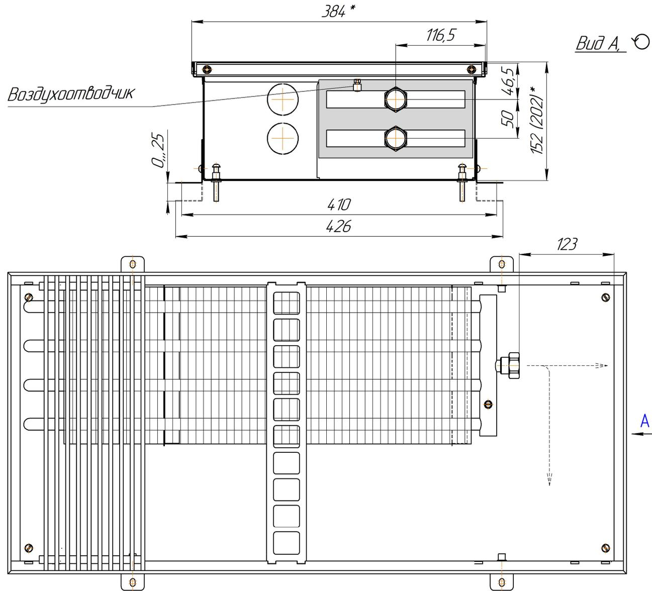
Монтажная схема ZOLTER ZN 380.150 (200) 2,5-5,0м
