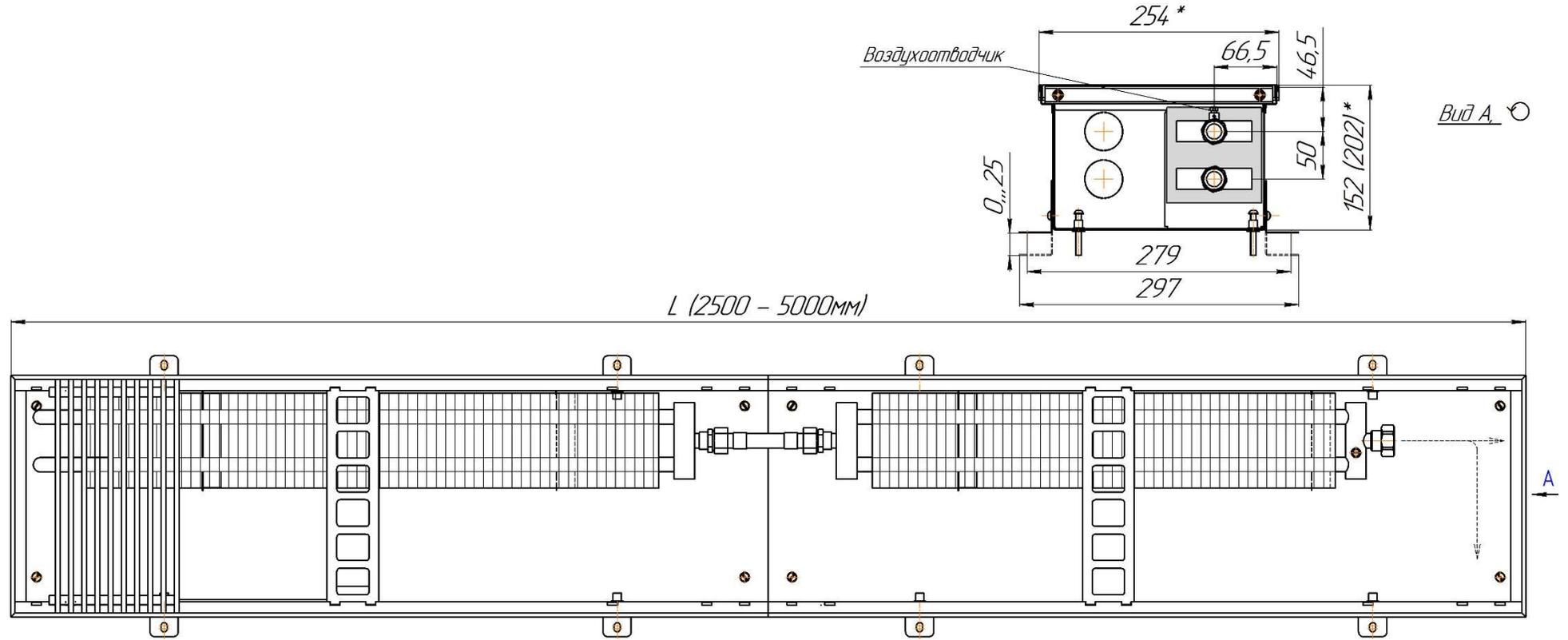
Монтажная схема ZOLTER ZN 250.80 (90, 110) 0,8-2,4м
