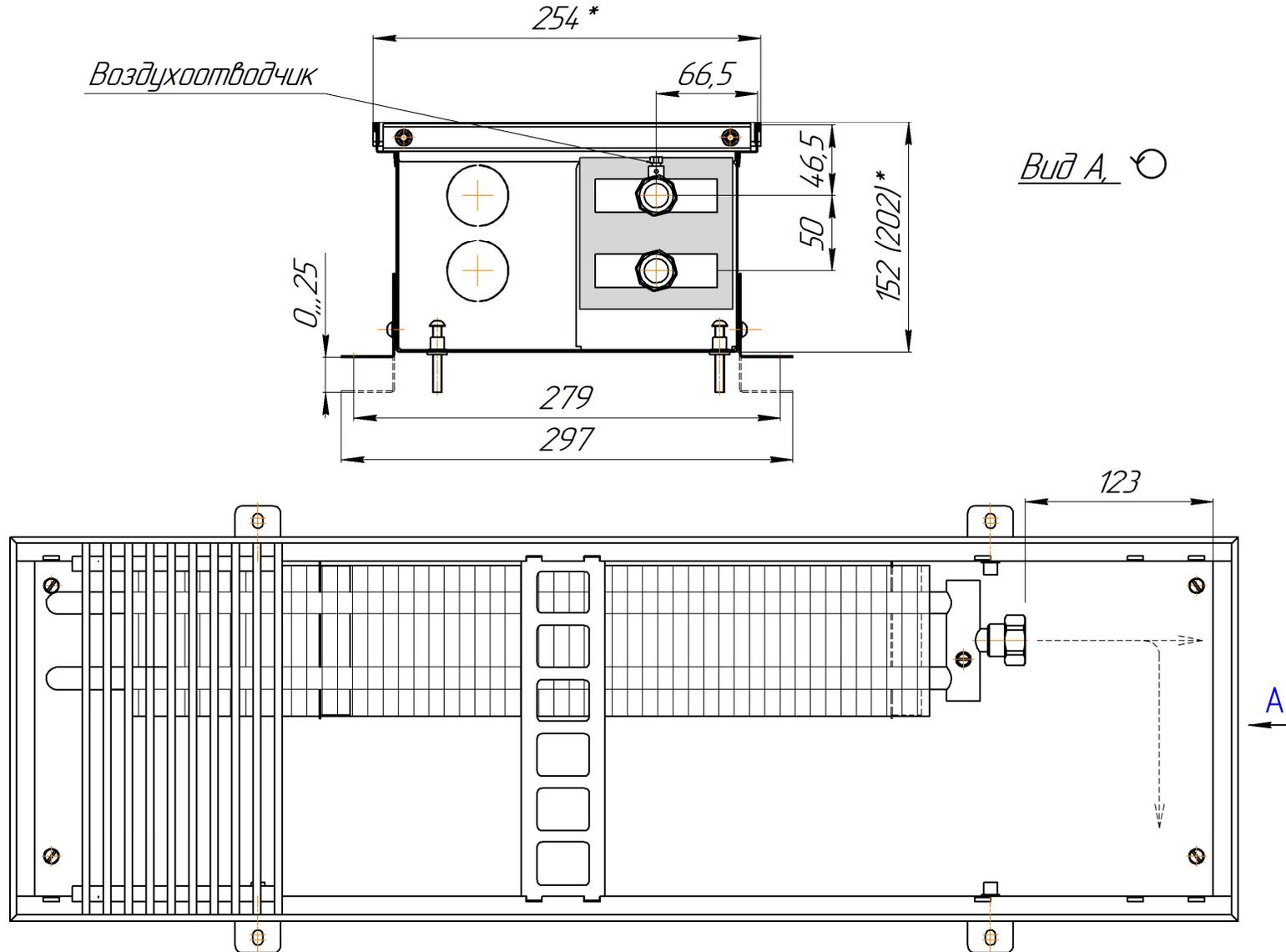
Монтажная схема ZOLTER ZN 250.150 (200) 2,5-5,0м
