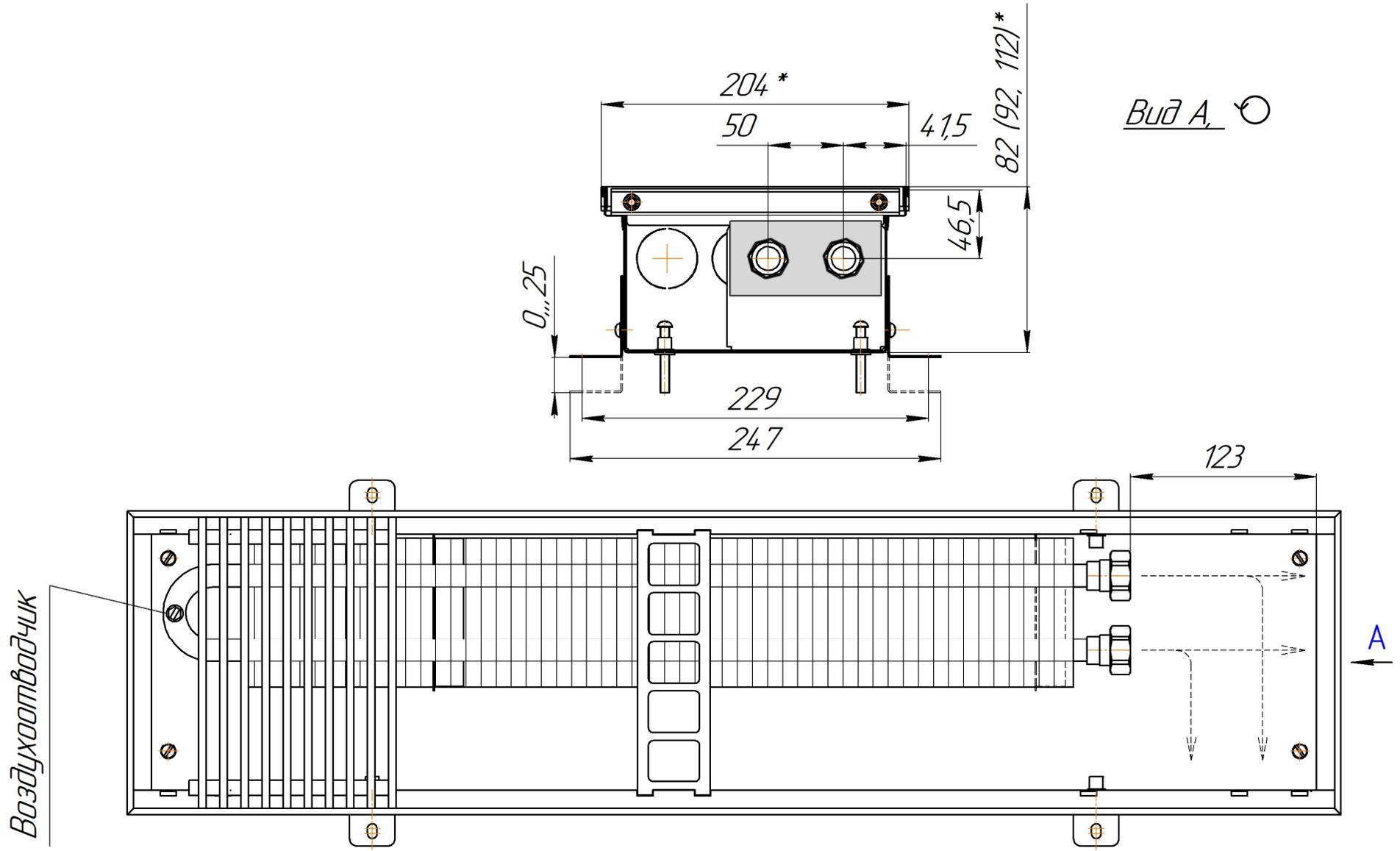
Монтажная схема ZOLTER ZN 200.80 (90,110) 2,5-5,0м
